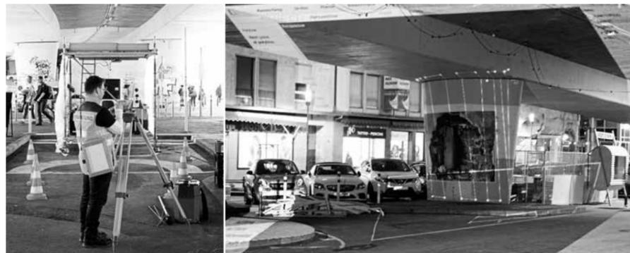
Zuerst wurde der Platz zur Erstellung eines digitalen Modells vermessen und gescannt. Mit einer Projektion wurde dann die Umgebung mit dem digitalen Abbild überlagert und stellenweise synchronisiert. Fotos: Tamara Wirth
