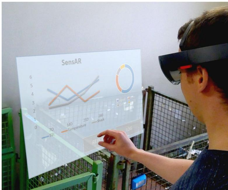
Abbildung 31: Sensor\_Vision, das Augmented Reality im Einsatz darstellt
