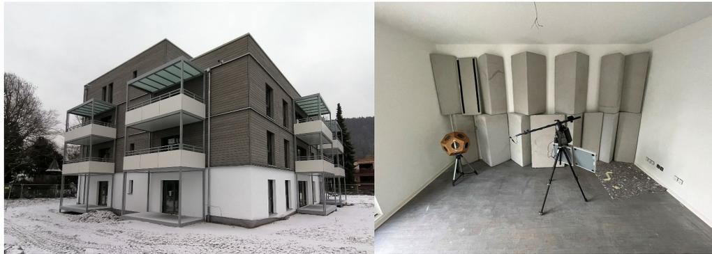
Abbildung 7: Akustikforschung im Holz-Beton Hybridbau. Messung der Nachhallzeit mit Absorbern
