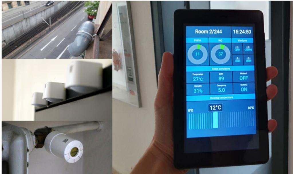
Abbildung 34: Smart Public Buildings - Feinstaubsensor, Multisensor und smartes Thermostat; User Interface (basierend auf dem HABpanel von openHAB) zur Darstellung und Steuerung der Geräte auf einem Tablet.
