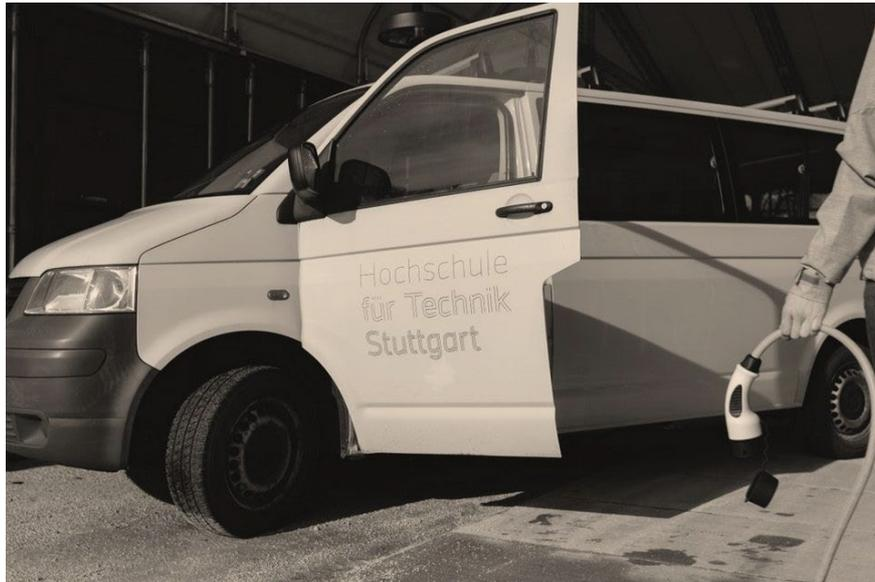
Abbildung 19: Durch ein eingeworbenes Preisgeld konnte ein herkömmlicher VW-Bus der Hochschule auf Elektroantrieb umgerüstet werden
