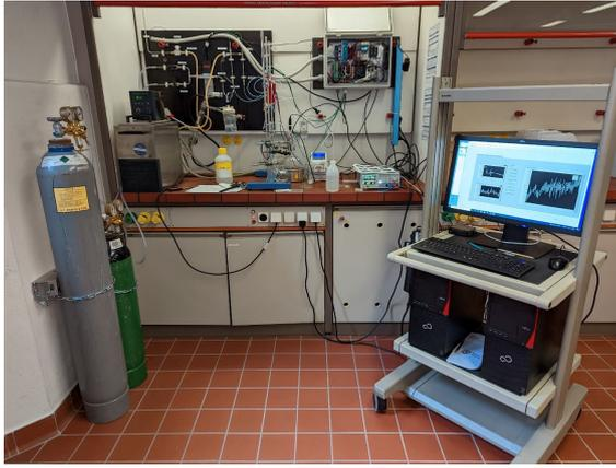
Abbildung 29: Prototyp des CO<sub>2</sub>-zu-Ameisensäure-Elektrolyseurs
