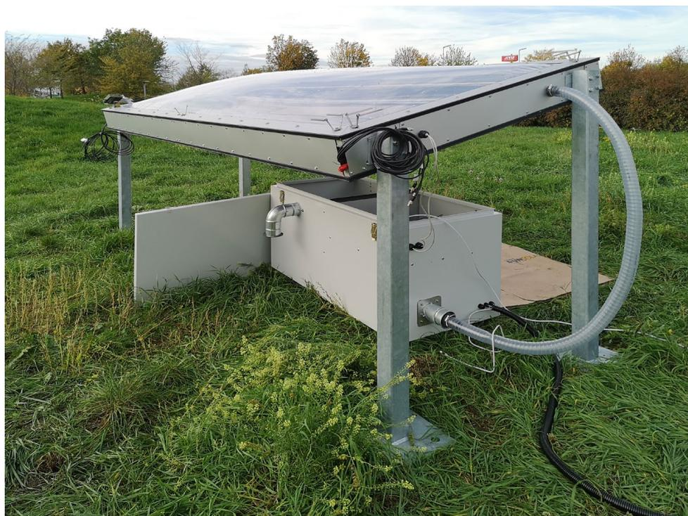
Abbildung 17: Evo-control 2.0 - ETFE-Kissen, beispielhafter Testaufbau im Maßstab 1:1 (Quelle: Hansjörg Zabel/ ITF)
