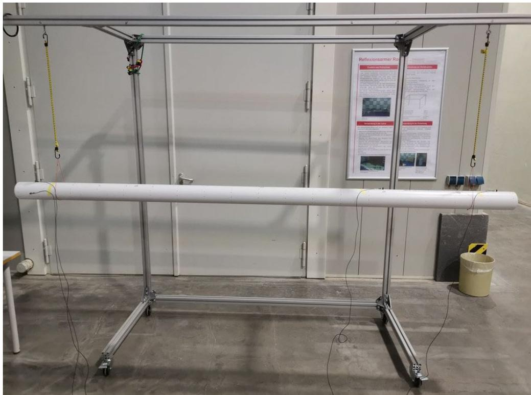
Abbildung 36: Frei aufgehängtes Abwasserrohr mit montierten Beschleunigungsaufnehmern
