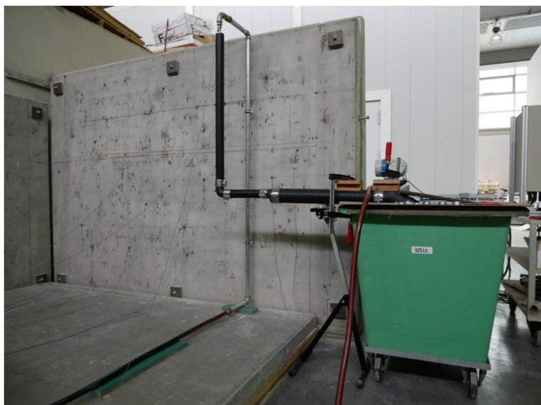
Abbildung 35: An einer Empfangsplatte montierte Trinkwasserleitung
