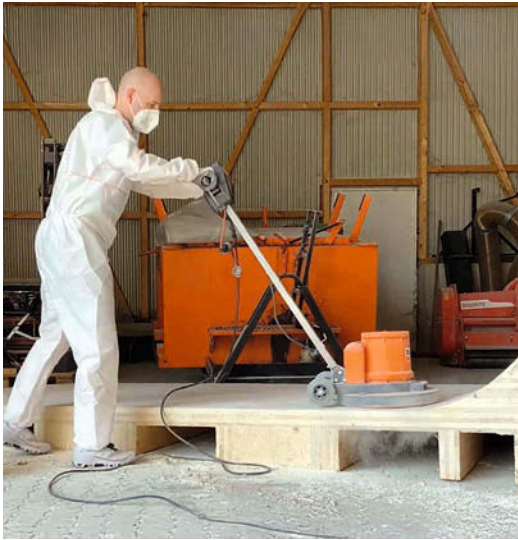
In einem Workshop vor Ort veredelten Studierende die Oberflächen der Schalungselemente und bauten fehlende Passtücke. • In an on-site workshop, students refined the formwork elements and built missing fitting pieces.
